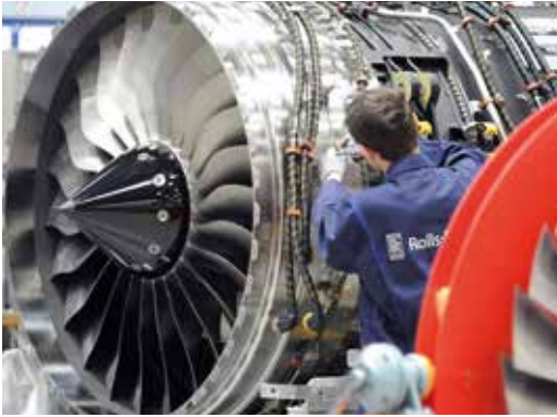
Montage eines BR725 Triebwerks bei Rolls-Royce in Dahlewitz
